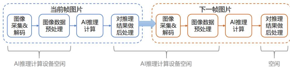
若能提升 AI 推理设备的利用率，则可以提高 AI 程序的吞吐量。**提升 AI 推理设备利用率的典型方式**，是将同步推理实现方式更换为异步推理实现方式。
