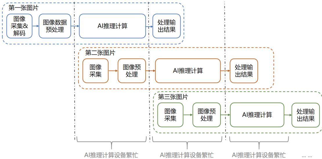
使用 `benchmark_app` 工具，并指定实现方式为同步(sync)或异步(async)，观察性能测试结果，异步方式的确能提高吞吐量，如下图所示：
